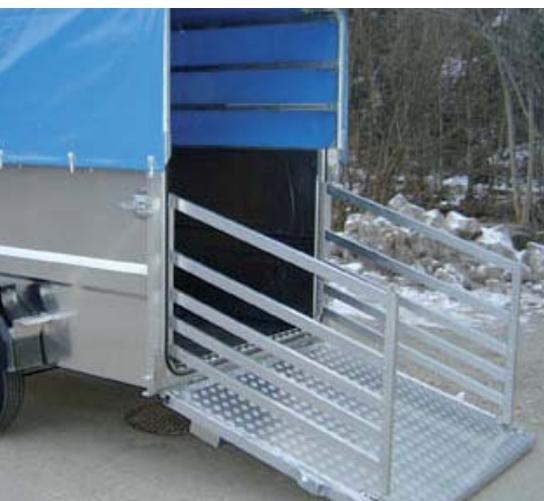
Das Abschlussgitter kann ausgeklappt werden und dient so als Ladegitter. La grille de fermeture peut être ouverte vers l'extérieur et sert ainsi de barrière de chargement. (Photo: Tanner AG, Langnau)
